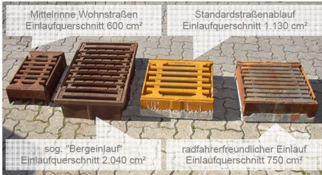
Einlaufquerschnitte unterschiedlicher Straßenabläufe
