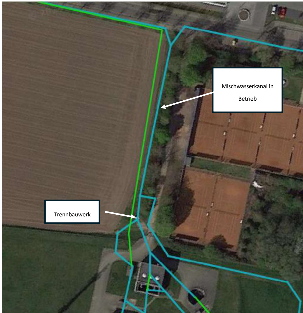
Abbildung 65 | Verlauf der zum Pumpwerk laufenden Abwasserleitungen (Quelle: Stadt Rees, DSK eigene Darstellung)
