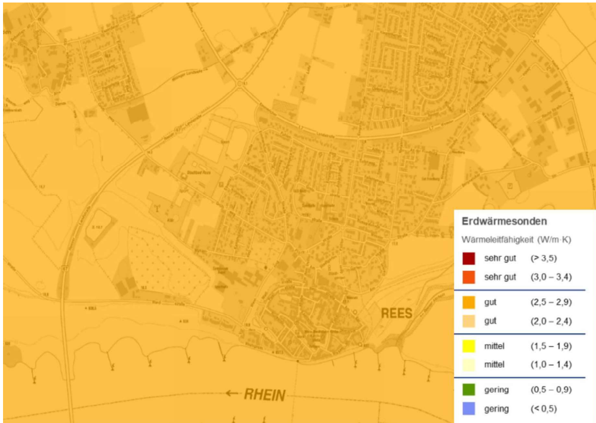
Abbildung 62 | Wärmeleitfähigkeit des Bodens bei Rees in einer Tiefe ab 100m bis 1000m (Quelle: DSK, eigene Erhebung)
