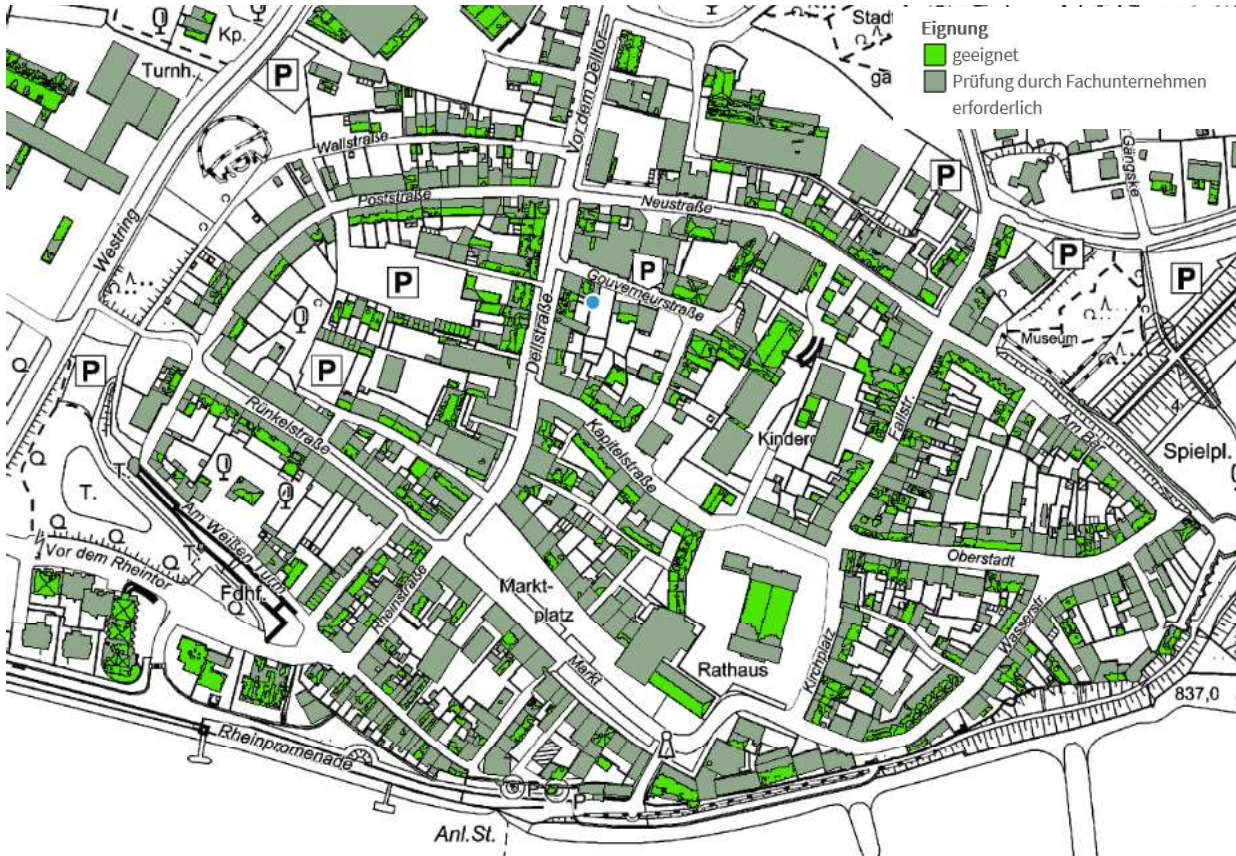
Abbildung 55: Ausschnitt Solarkataster NRW, Darstellung der geeigneten Dachflächen für solarthermische Anlagen im Quartier Nordost (Quelle: LANUV)
