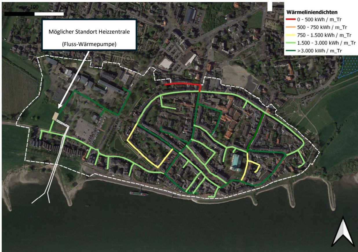
Abbildung 78 | Berechnete Wärmelinendichten im Quartier für ein Szenario „Großwärmepumpe-Rheinwasser“ (Quelle: DSK, eigene Darstellung)
